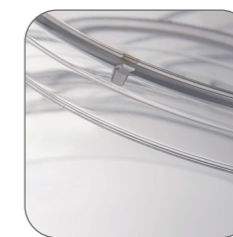
培养皿盖的缺口式设计,保持无菌的同时利于气体交换
